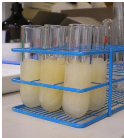
Figura 2.8. PUFs e solvente no interior dos vasos da MAE.
