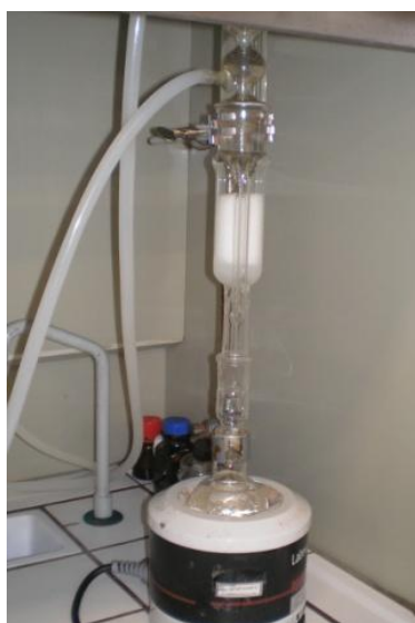
Figura 2.9. Soxhlet usado para a extracção dos PAHs das PUFs.
