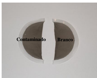
Figura 2.6. Filtro contendo uma amostra de \text{PM}_{10} , cortado em duas partes, para ser usado nos ensaios de recuperação.
