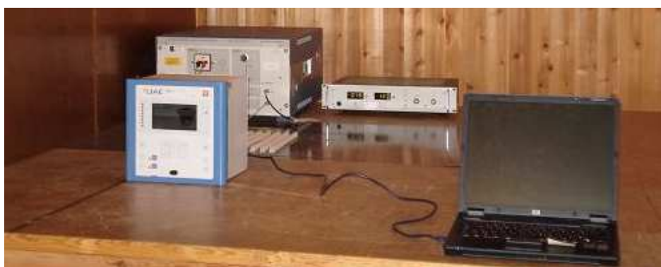
Figura 6.10 - Arranjo do equipamento para o ensaio de Emissão Conduzida.
