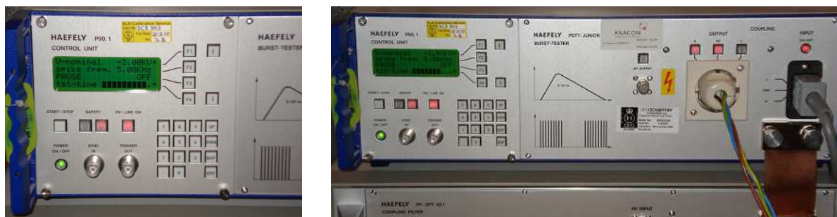
Figura 6.16 - Gerador de Transitórios.
