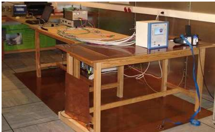
Figura 6.19 - Arranjo do equipamento para o ensaio de Imunidade a Descargas Electrostáticas.
