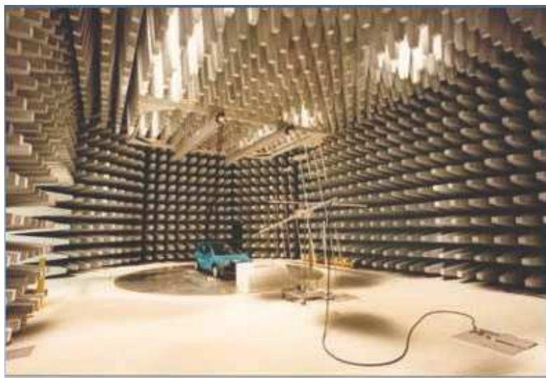
Figura 5.4 - Câmara Semi-Anecóica [I 5].
