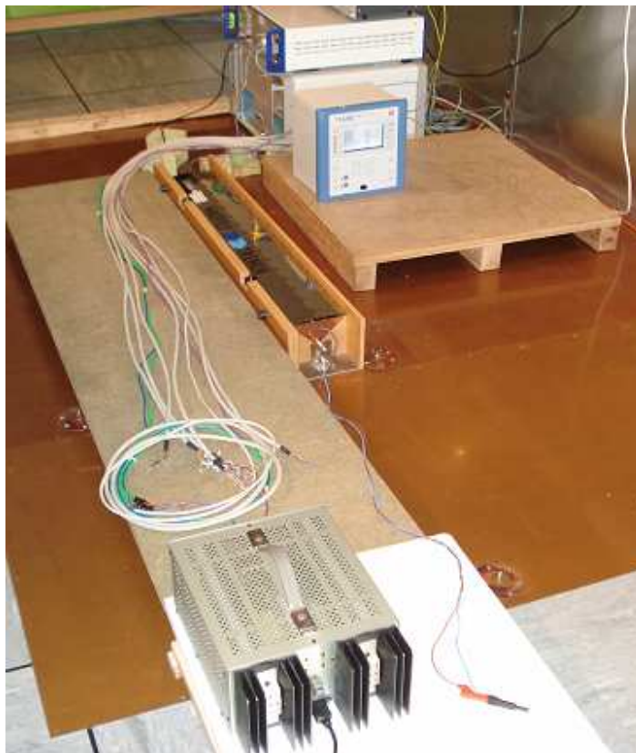
Figura 6.17 - Arranjo do equipamento para ensaio de Imunidade a Transitórios Eléctricos Rápidos.
