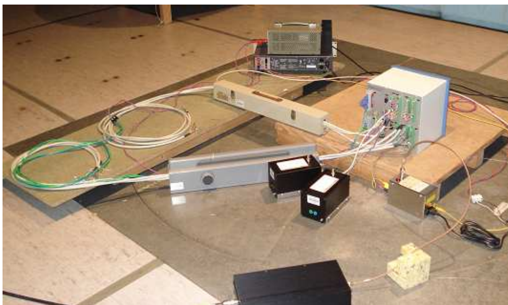
Figura 6.13 - Arranjo do equipamento para ensaio de Imunidade Conduzida.
