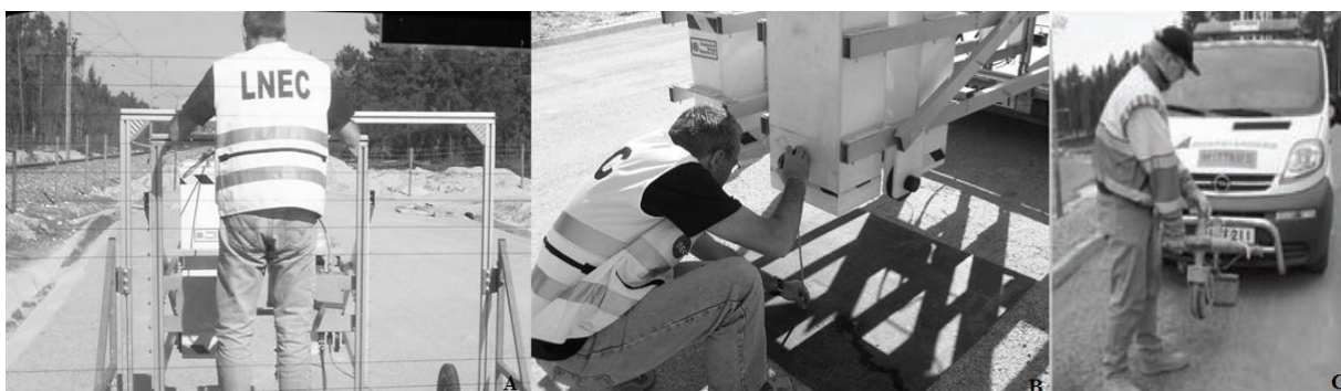
Fig.2.22 – Procedimentos típicos de calibração; A) teste de balanceamento; B) teste de posicionamento; C) teste de levantamento da antena [2].
