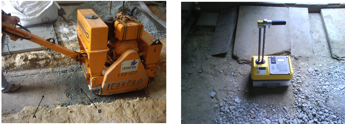
Fig.4.5 – Execução do trecho experimental. À esquerda um aspecto da compactação, onde A representa o material calcário e B o material granítico. À direita a determinação do teor em água através de um gamadensímetro.
