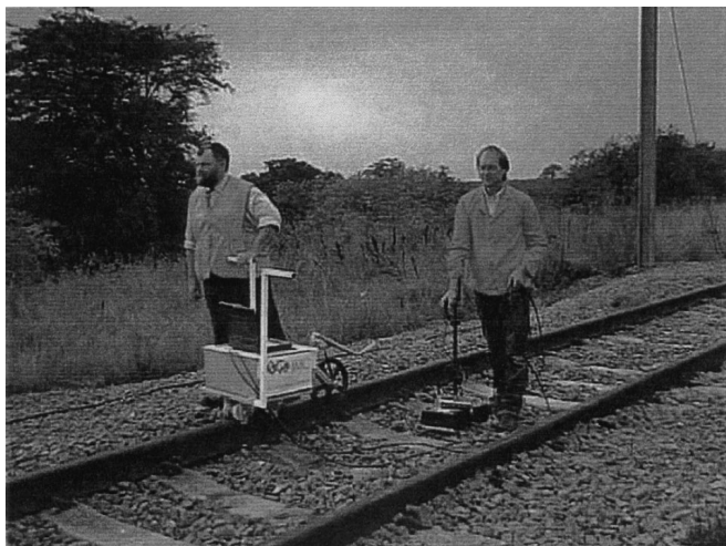
Fig.3.1 – Equipamento de georadar em uso. As dimensões reduzidas do equipamento permitiam que este se ajustasse aos intervalos entre travessas, facilitando a recolha de dados [17].
