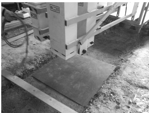
Fig.4.2 – Sistema de posicionamento das antenas durante o ensaio.
