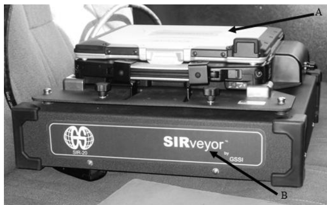
Fig.2.16 – A) unidade de armazenamento e visualização; B) unidade de transmissão e recepção (no sistema exemplificado, as unidades de transmissão e recepção e de controlo estão integradas).
