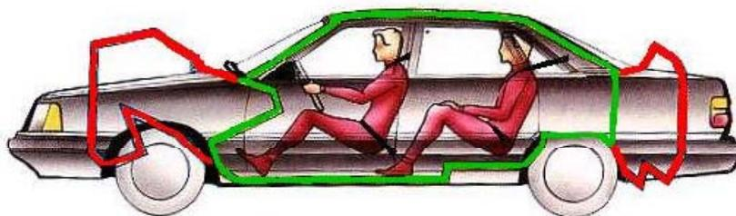
Figura 9 - Zonas deformáveis e zonas mais resistentes de um automóvel. [DGV, 2004]
