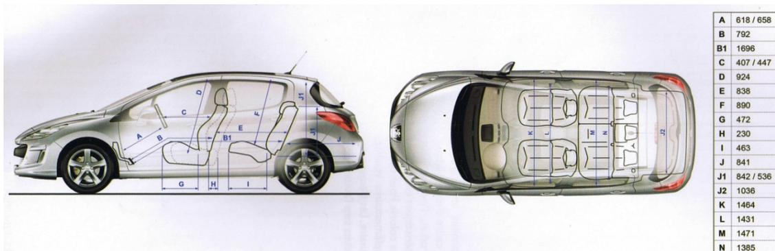
Figura 35 – Dimensões interiores do veículo. [Peugeot, 2007]
