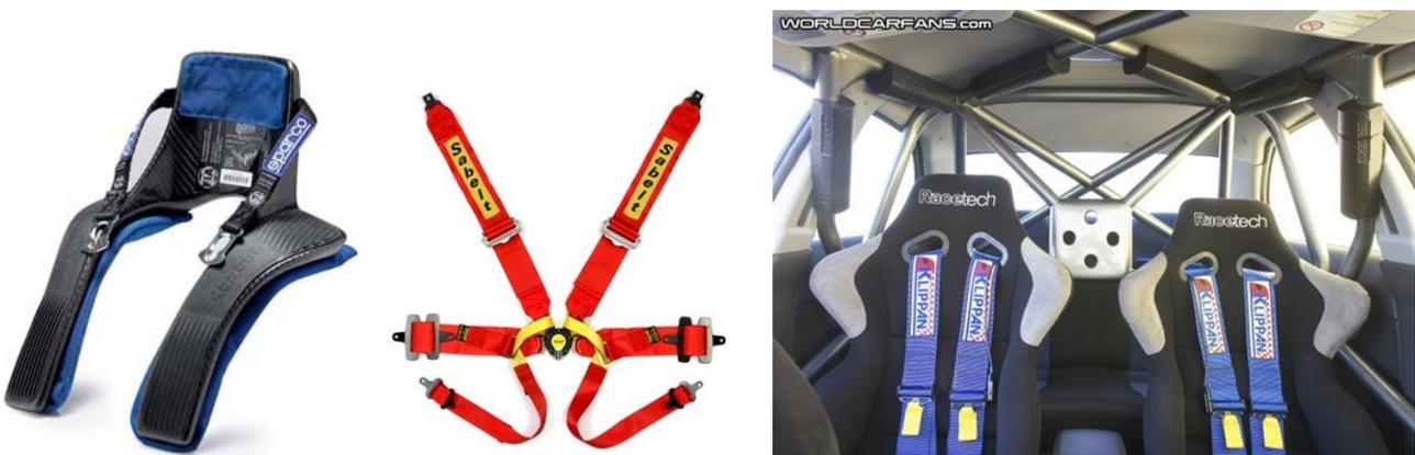
Figura 3 - Sistema "Hans" [qf, 2007], cintos de segurança 6 pontos [F1Classement, 2008], interior de um automóvel de competição [WCF, 2007]
