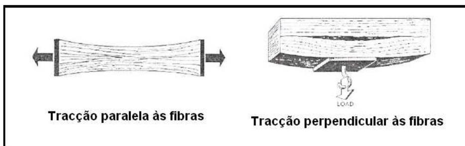
Figura 4.2 – Tracção da madeira na direcção perpendicular e paralela às fibras
