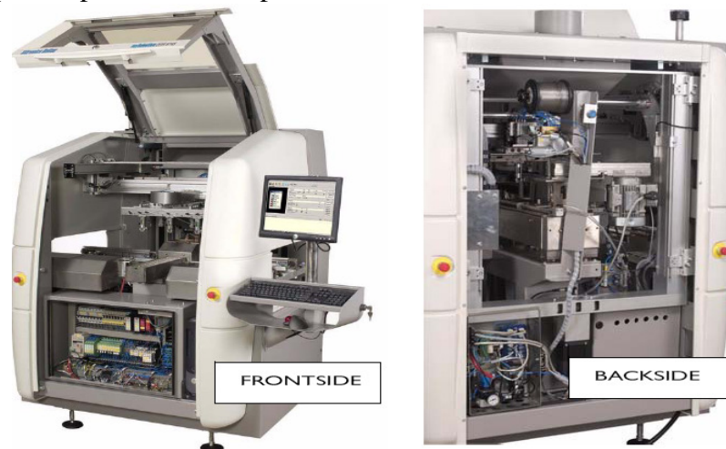
Figura 8 – Máquina de soldadura selectiva Soltec 6745 – Adaptado do manual da máquina
