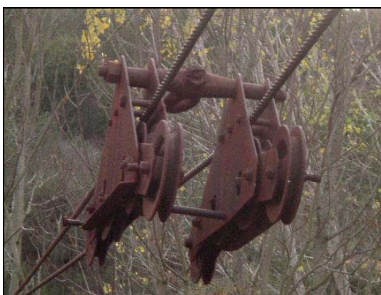
Figura 2.54 – Carro de transporte do minério suspenso por dois cabos.
