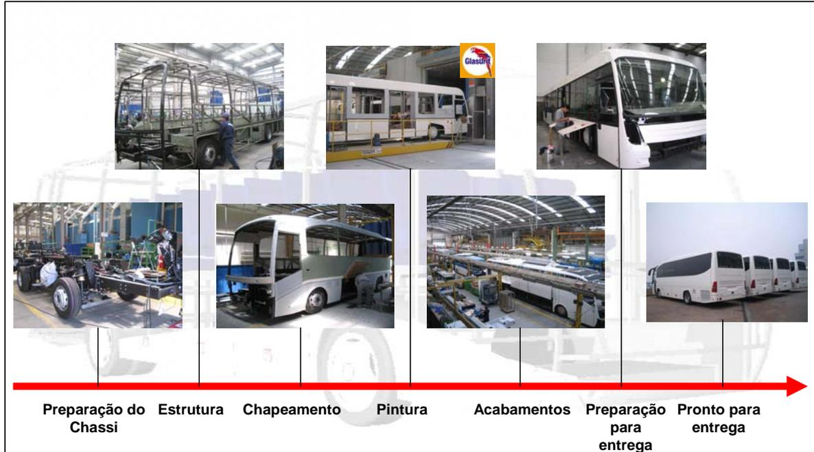
**Figura 4 - Sequência de Montagem de um Autocarro**
