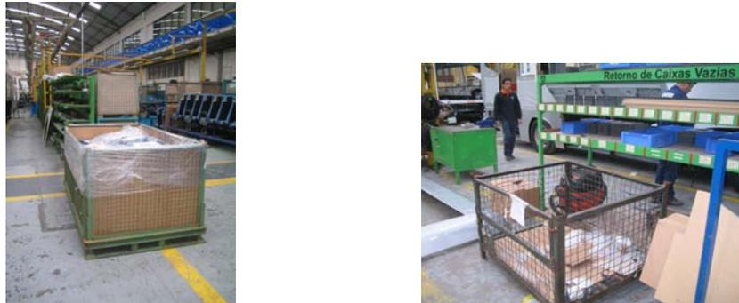
**Figura 7 – Acomodação errada dos contentores de *Picking* na Linha de Produção.**
