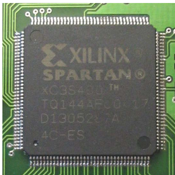
Figura 4.1 - Xilinx FPGA (Spartan XC3S400). Este FPGA possui 400000 portas lógicas e tem uma velocidade de relógio de 50 MHz
