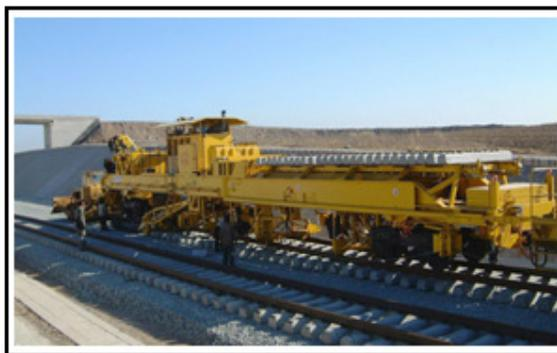
Fig.49 – Comboio de substituição (Adaptado de [41])
