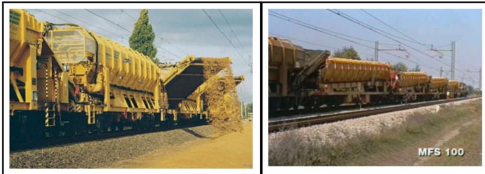
Fig.53 – Vagões de detritos (Adaptado de [41])
