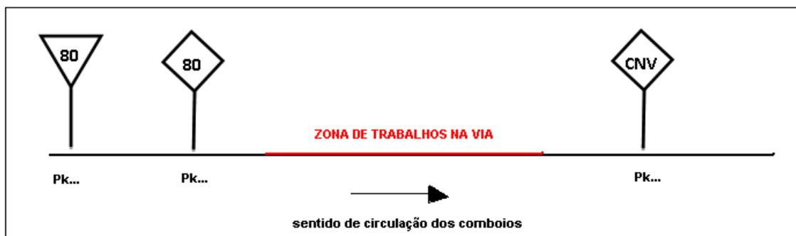
Fig.40 – Esquema de sinalização provisória em linha com afrouxamento
