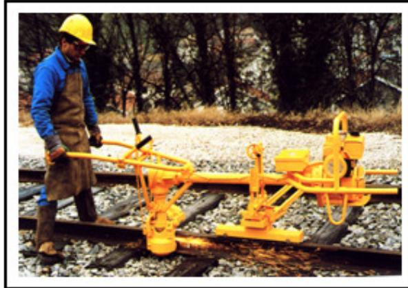
Fig.59 – Esmeriladora manual de carril [Adaptado da Web]
