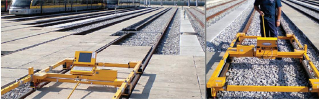
Figura 33 – Equipamento manual de registo contínuo - Trolley [Adaptado da Web]
