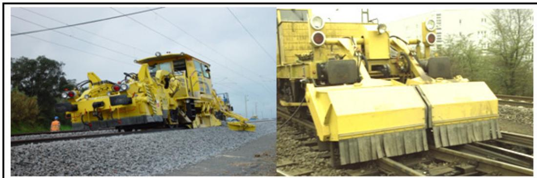
Fig.44 – Regularizadora de balastro (Adaptado de [41])
