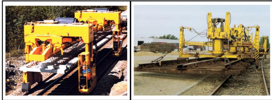
Fig.66 – Pórticos de substituição [Adaptado de 41, Adaptado da Web]
