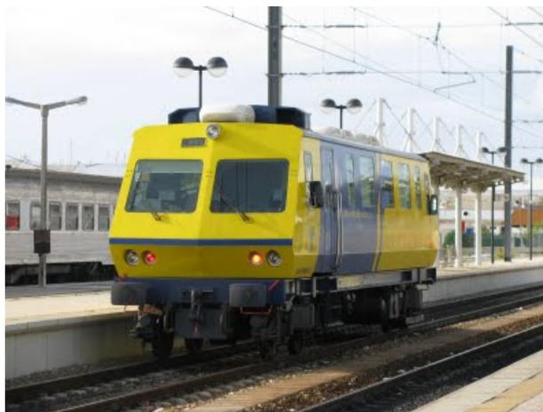
Figura 28 – Veículo de Inspeção de Via (EM -120) [Adaptado da Web]
