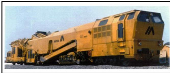
Fig.47 – Desguarnecedora de via [Adaptado da Web]
