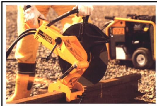
Fig.58 – Equipamento de cortar carril (Adaptado de [41])
