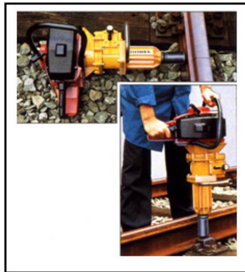
Fig.60 – Aparafusadora portátil [Adaptado da Web]
