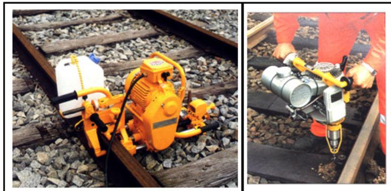
Fig.57 – Equipamento de furar carril e travessas [Adaptado de 41, Adaptado da Web]
