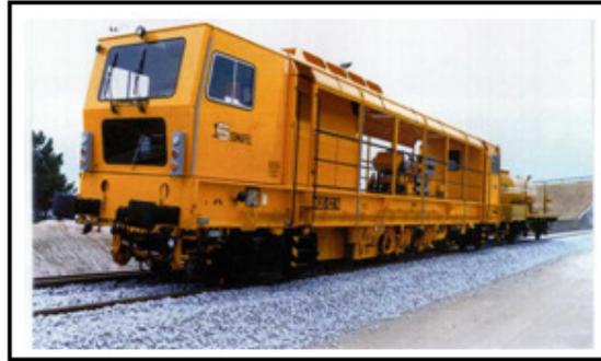
Fig.45 – Estabilizadora de via [Adaptado da Web]
