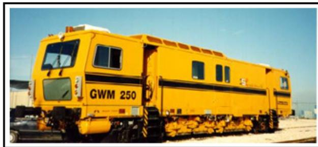
Fig.46 – Esmeriladora pesada de via (Adaptado de [41])
