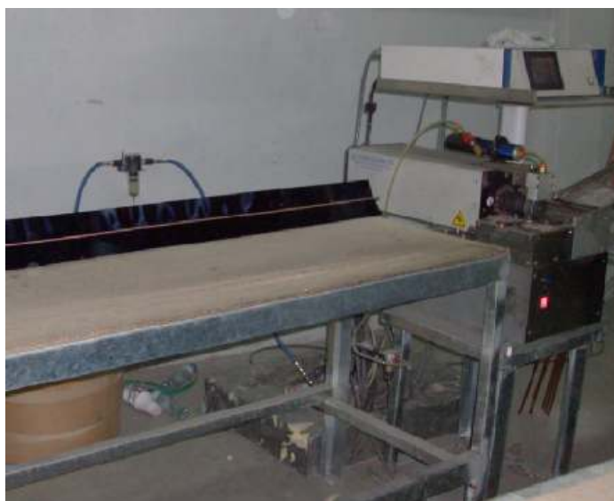
Figura A2.1 - Processo de soldadura do absorvedor aos tubos de cobre.
