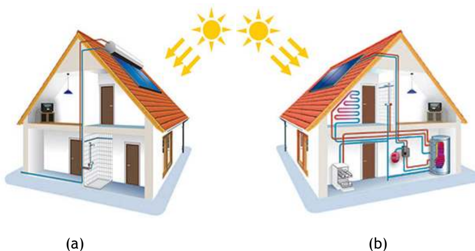
Figura 2.4 - Exemplo de montagem de colectores solares térmicos por: (a) circulação natural (sistema de termossifão) e (b) circulação forçada (adaptado de [13]).
