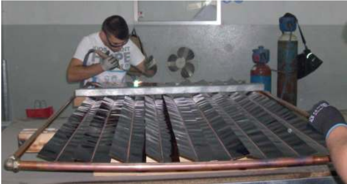
Figura A2.2 - Processo de soldadura da grelha.
