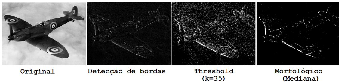
Figura 3.18: Amostra de imagem filtrada pela cadeia de filtros de detecção de bordas, threshold e morfológico.
