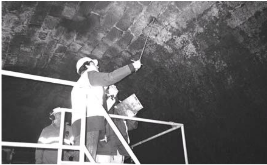
Fig.15 - Prospecção de vazios no extradorso (GEG)
