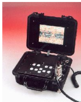
Fig.5 – Exemplo de georadar (Esteio)
