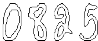
Figura 3.12 - Dígitos após a aplicação do filtro edges.
