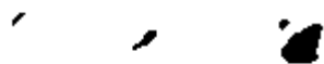
Figura 4.14 - Imagem após o floodfill, donde se poderá retirar o número de blobs.
