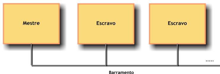
Figura 2.22 - Interligação de nós usando o barramento LIN
