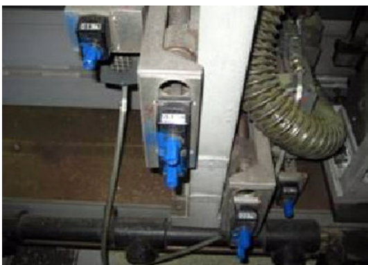
Figura 24 e 25 . Parafusos para Regulação das Diferentes Ferramentas nas Linhas Homag do Canteado
