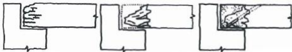
Fig. 54 – Reforço com barras com remoção apenas da parte degradada (Arriaga [21])
