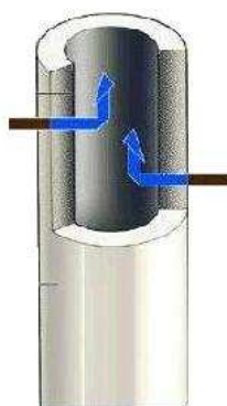
Figura 2-5 - representação esquemática das fibras constituintes da membrana.
