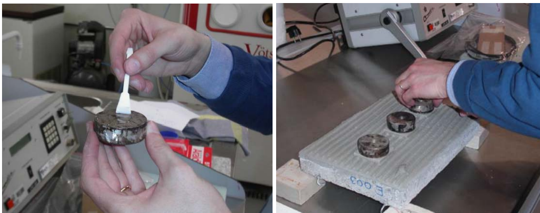
Figura 4.20: Colagem das pastilhas metálicas com cola de alta resistência
