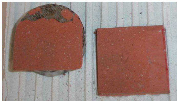
Figura 4.36: Rotura coesiva no seio do ladrilho cerâmico – Provete PE4.1.
