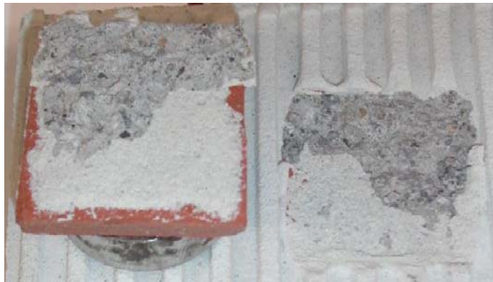
Figura 4.35: Rotura coesiva no seio do suporte – Provete PE4.1.
