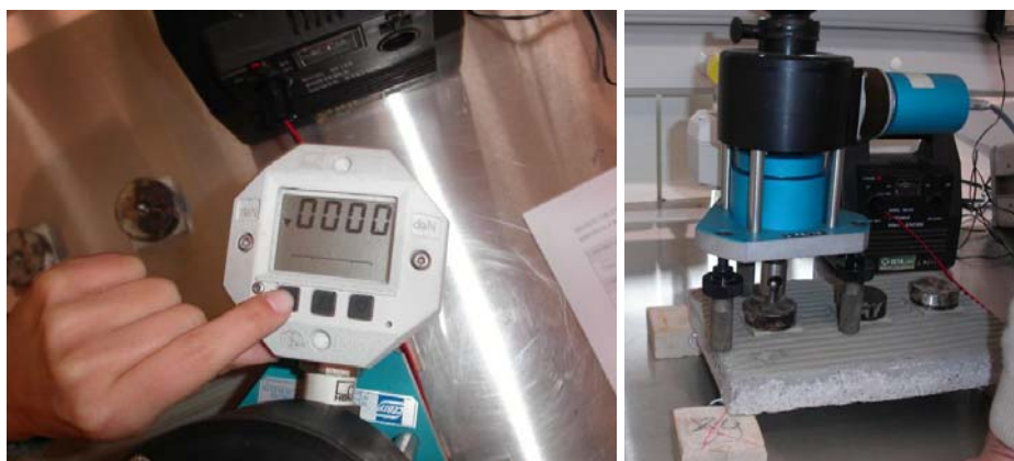
Figura 4.21: Ensaio de determinação da resistência à tracção de cimentos-cola – E1
