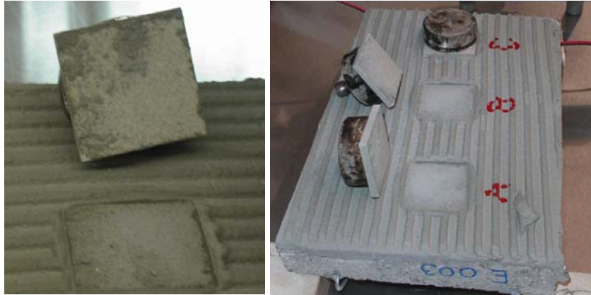
Figura 4.34: Rotura adesiva na interface entre o ladrilho cerâmico e o cimento-cola – Provete PE0.2.
