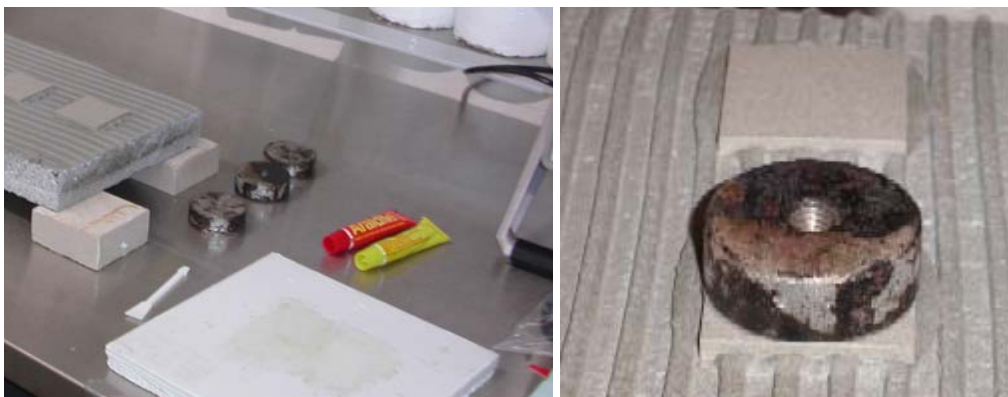
Figura 4.19: Cola de alta resistência e pastilha metálica cilíndrica.
