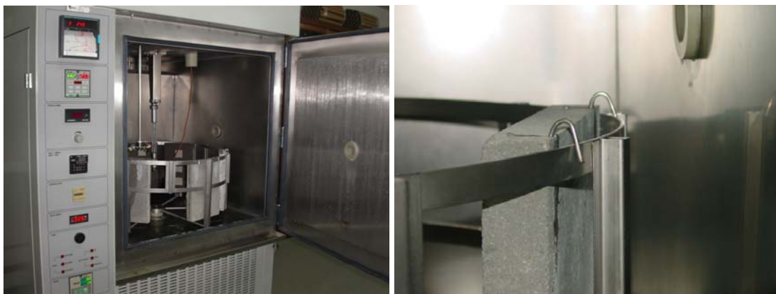
Figura 4.1: Condicionamento dos provetes no interior da câmara de envelhecimento acelerado.
