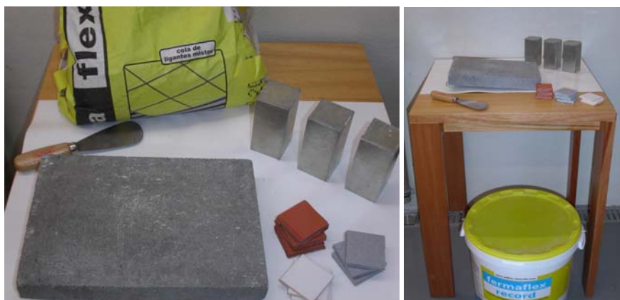
Figura 4.5: Componentes do sistema de revestimento cerâmico utilizados na preparação dos provetes de ensaio: placas de betão, cimentos-cola e ladrilhos cerâmicos
