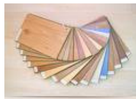
Fig. 3.23 – Placas de “HDF” folheadas p/ pavimento
