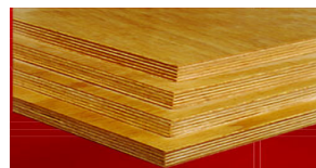
Fig. 3.17 – Exemplo de aplicação de contraplacado lamelado
