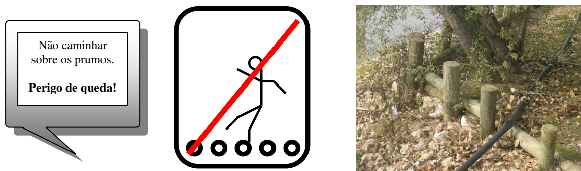
Fig. 4.5 – Exemplo de aplicação de pictogramas, indicando as condições de utilização, junto de prumos de contenção
