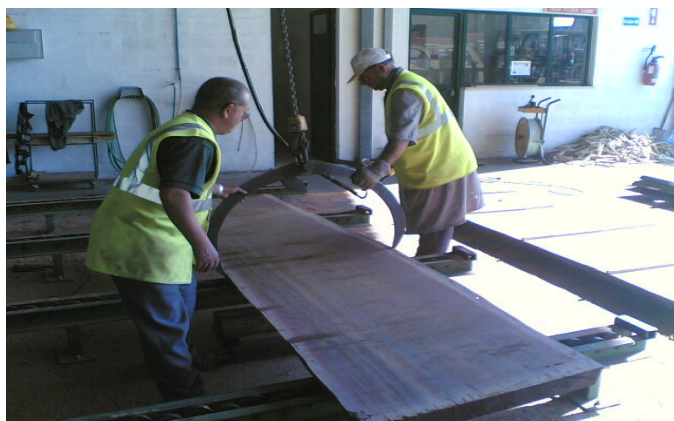
Fig. 3.13 – Obtenção de pranchas após serragem do toro
