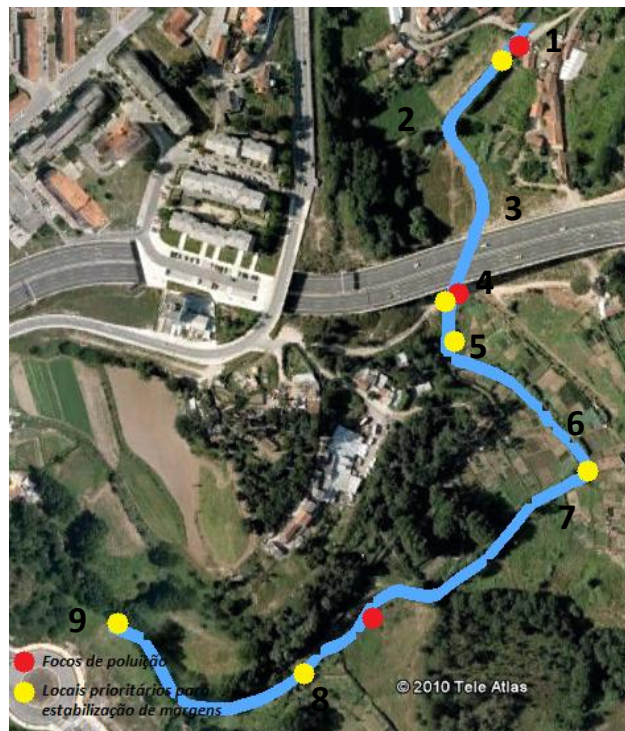
Figura 4.10 - Identificação do troço-piloto a reabilitar e dos respectivos focos de poluição e locais prioritários para estabilização de margens
