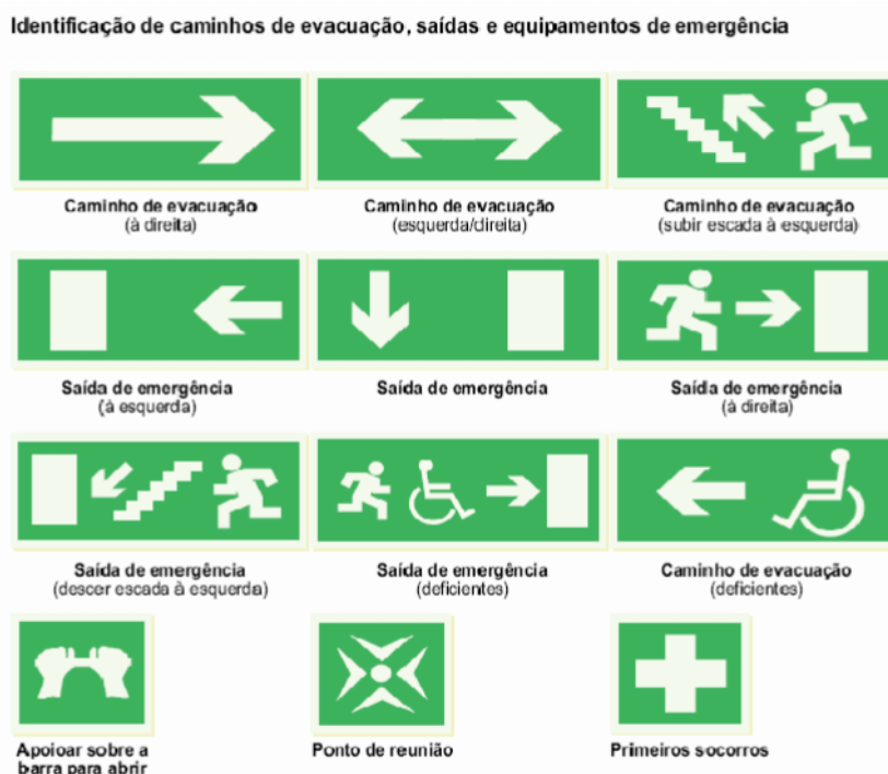
Fig.3.5 – Sinalização de evacuação [18].
