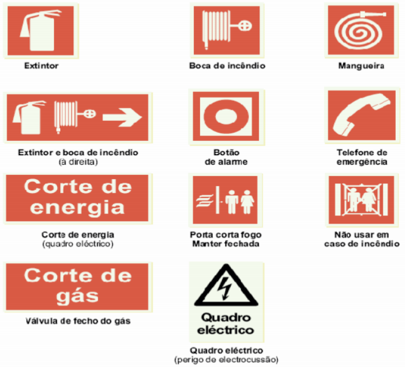
Fig.3.6 – Sinalização de equipamentos de segurança [18].
