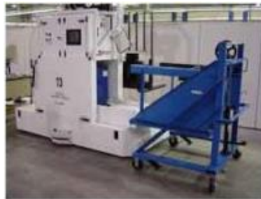
Figura 2.1: Substituição manual de baterias
