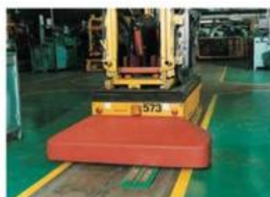
Figura 2.4: Recarregamento de baterias durante a produção
