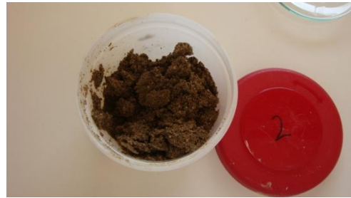
Ilustração 34: Amostra de solo 2 para ensaio de Lixiviação e de Geração Líquida de ácido.
