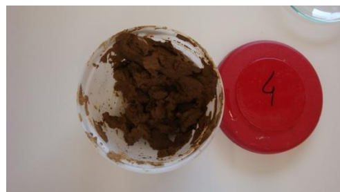
Ilustração 36: Amostra de solo 4 para ensaio de Lixiviação e de Geração Líquida de ácido.
