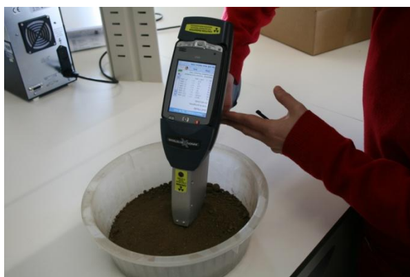
Ilustração 29: Aparelho de Espectrometria de Fluorescência de Raios-X da Innov X Systems.
