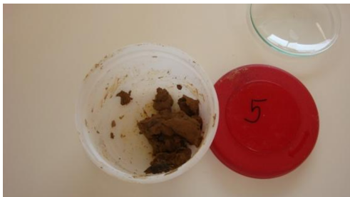
Ilustração 37: Amostra de solo 5 para ensaio de Lixiviação e de Geração Líquida de ácido.
