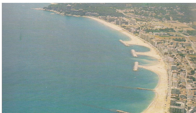
Fig.C.52. – Campo de quebramares destacados e esporões na praia de Güimar, Tenerife (Taboada, 1988).
