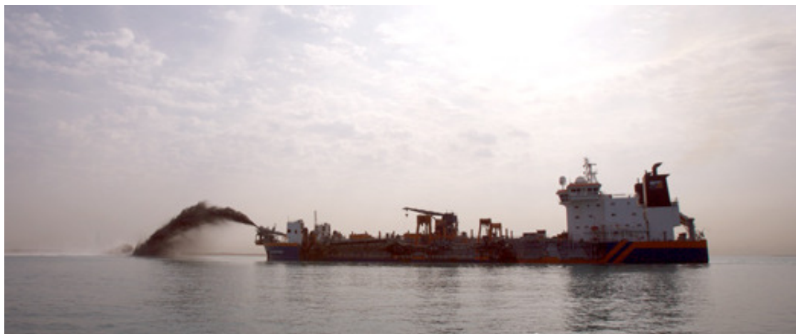
Fig.2.30 – Dragagem lançando sedimentos por repulsão por jactos ( http://www.theworld.ae/imageGallery.html ).
