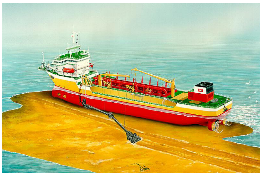
Fig.2.31 – Dragagem de sucção não estacionária (Loza, 2008).
