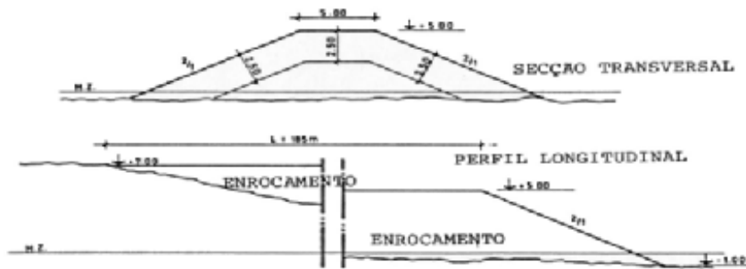
Fig.B.1 – Perfil transversal e longitudinal de uma solução simples de enrocamento (Veloso Gomes, 2008).
