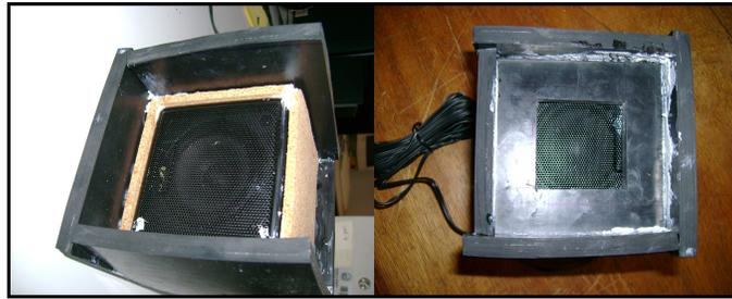
**Figura 7.2** - Caixa de cortiça e altifalante para coluna doméstica. Esquerda: interior da caixa de borracha com detalhe da caixa em cortiça. Direita: Vista geral da caixa de borracha antes da aplicação da tampa em forma de tronco de cone facetado no topo.
