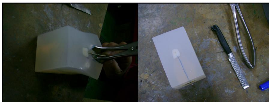
**Figura 6.11** - Remoção do protótipo do interior da silicone.
