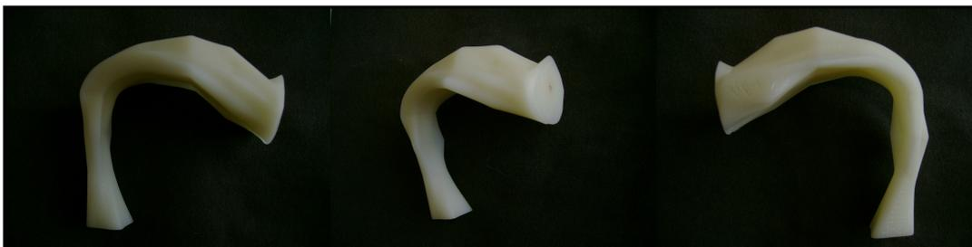
**Figura 6.9** - Protótipo sólido do tracto vocal produzido por estereolitografia – três vistas.
