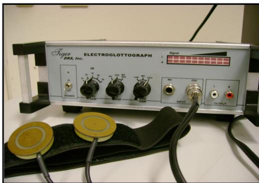
**Figura 2.6** - Electroglotógrafo EG-PC3 da Tiger DRS, Inc. Unidade e eléctrodos em banda flexível.
