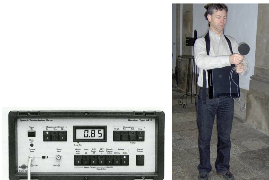
Fig.3-14 (A e B) – Unidade receptora do RASTI, com microfone omnidireccional
