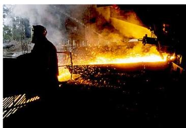
Fig.28-Extracção da escória de alto-forno
