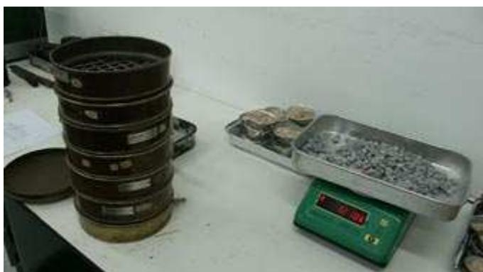
Fig.12- Análise granulométrica de agregados
