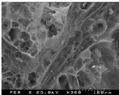
Fig.26- Microestrutura da perlite expandida
