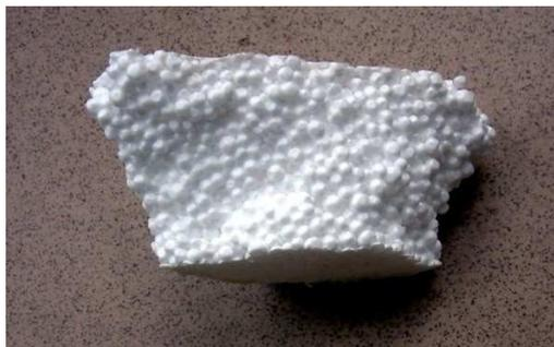
Fig.31- Poliestireno expandido
