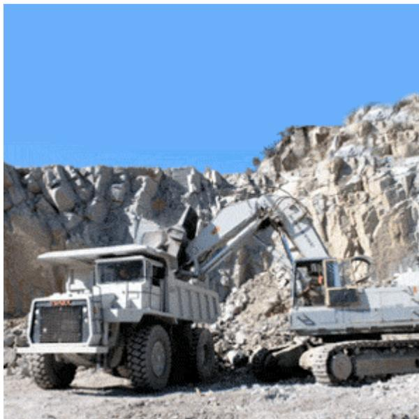
Fig.11- Exploração de maciço rochoso para obtenção de agregados
