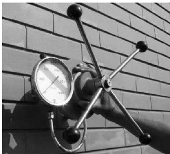
Fig.37- Exemplo de uma máquina *pull – off*
