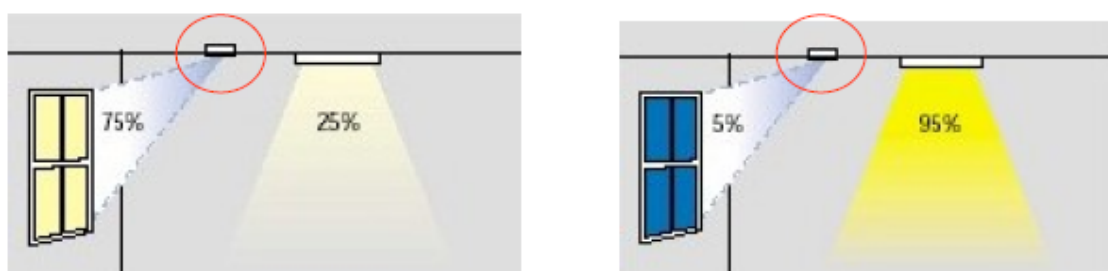
Figura 2.17- Exemplo do funcionamento dos sensores de luminosidade
