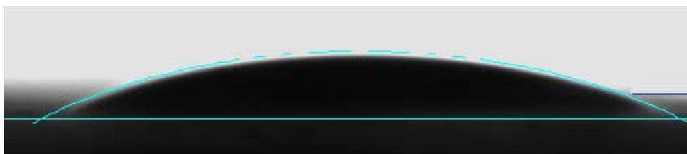
Figura 14 - Aspecto de uma gota colocada numa superfície hidrofílica.
