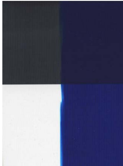
Figura 15 - Carta de contraste para o “ensaio da gota”.
