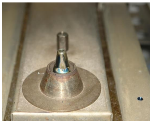
Figura 26 - Definição do Local para Medição da Temperatura de Solda (SOLTEC 6745)
