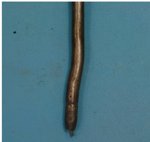
Figura 22 – Definição da Profundidade para Medição da Temperatura de Solda
