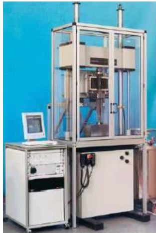
Figura 2.7. Imagem do modelo VHS 50/20 da marca INSTRON®, capaz de forças de 50 kN e 20 ms -1 .
