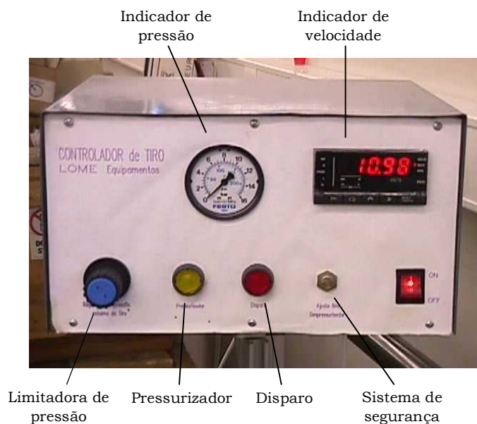
Figura 6.11. Controlador de tiro.
