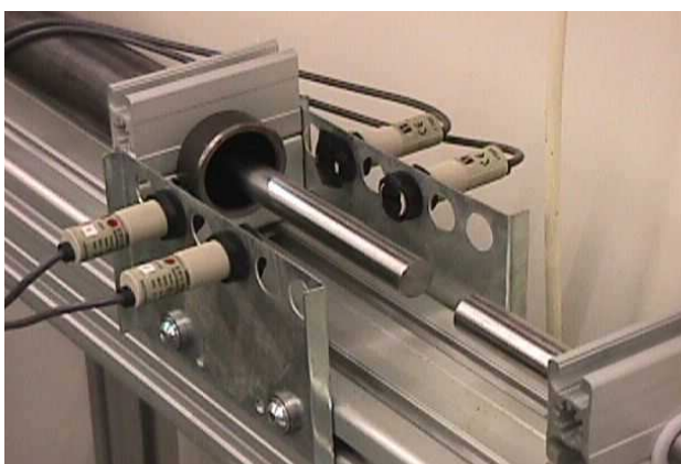
Figura 6.13. Células foto eléctricas para detecção de velocidade.
