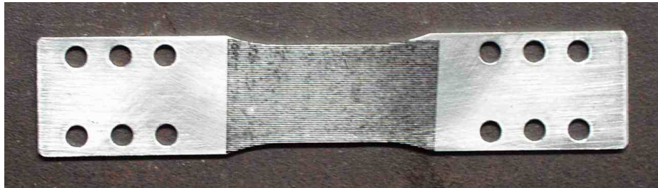
Figura 8.4. Provete de alumínio para ensaio de tracção com uma rede de linhas horizontais gravada na sua superfície.
