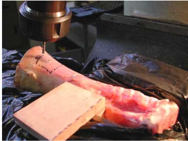
Figura 7.7. Pormenor da retirada de provetes de tecido ósseo de um fêmur bovino.
