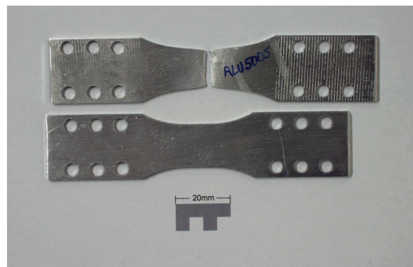
Figura 8.1. Forma típica dos provetes de alumínio ensaiados em tracção e deformação após rotura.
