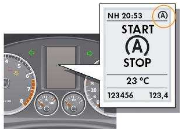
Figura 103 – Ecrã do quadro de instrumentos com a indicação do Start-Stop activo. O tipo de visualização no ecrã do quadro de instrumentos diferencia-se segundo o equipamento de conforto do veículo, aqui a versão highline.
