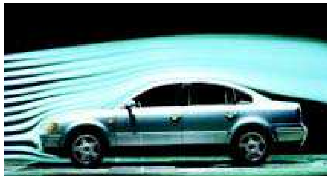
Figura 80 – Teste de aerodinâmica no VW Passat de 1998. Fonte: Autodidático número 192 da VW.
