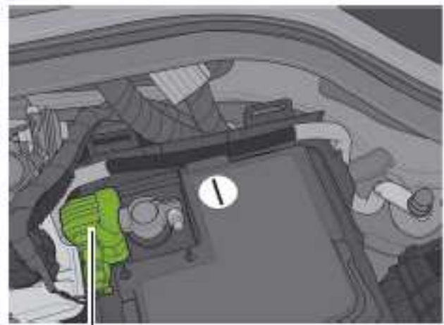
Figura 145 – Sensor da bateria na unidade de controlo para vigilância da bateria no borne de conexão do cabo à massa. Fonte: Autodidático 430 da VW.
