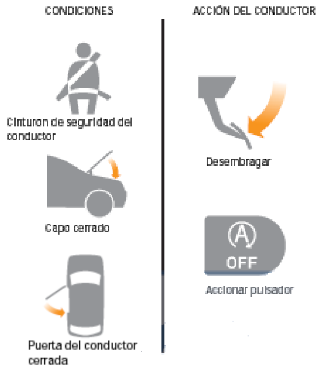
Figura 136 – Resumo esquemático das condições do veículo e do condutor para o sistema Start-Stop arrancar o motor com a intervenção do condutor.
