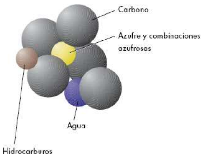
Figura 89 – Partículas materiais, constituídas por fuligem e compostos inorgânicos (sulfatos, água e cinzas).
