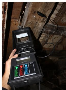
Fig. 4.36 – Utilização do humidímetro.
