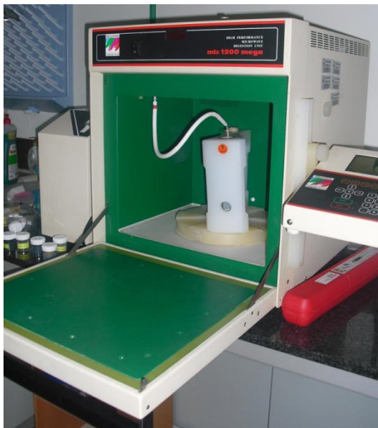
Figura 4 - Microondas utilizado para a síntese de VS-1
