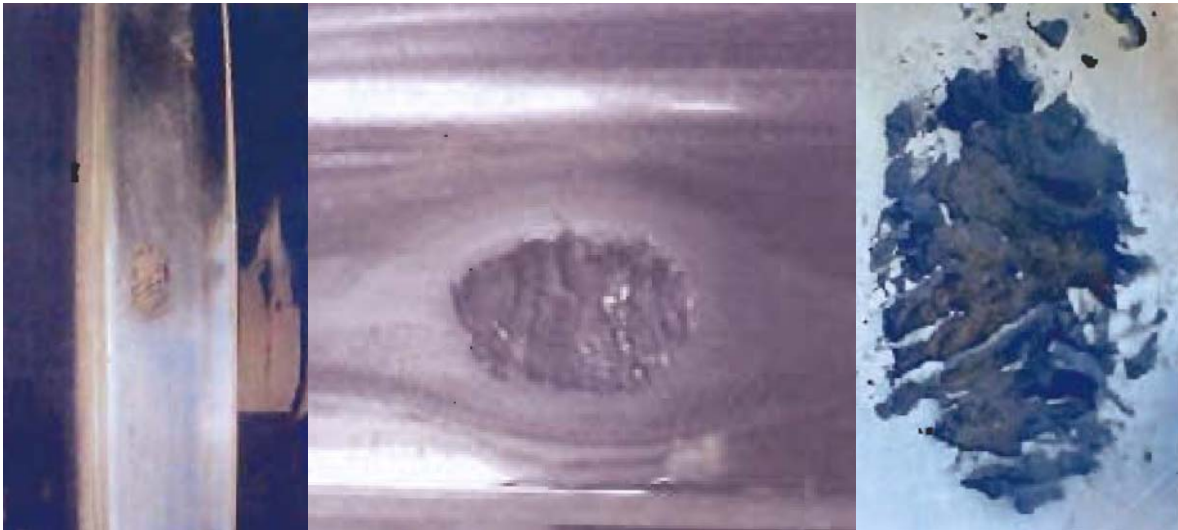
Fig. 1.10: Fotografias de uma escama com origem abaixo da superfície da roda, [10].
