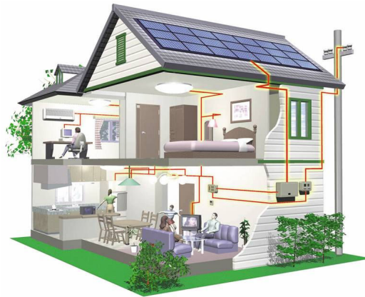
Figura 2.18 – Sistema sem baterias [F16].
