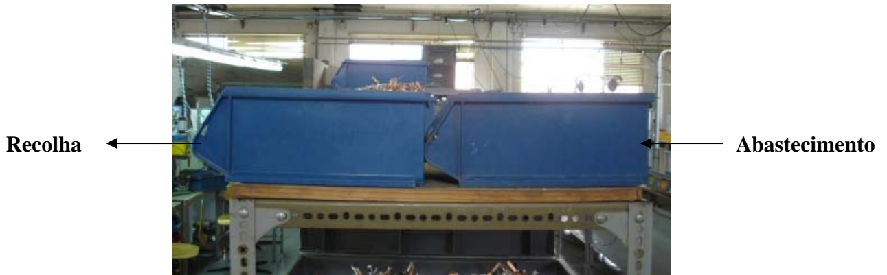
Figura 17 – Sistema First In First Out (FIFO)
