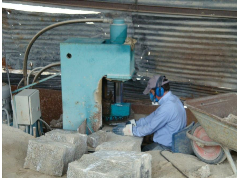
Figura 15 - Operário a executar a sua função numa máquina de quebra de blocos.
