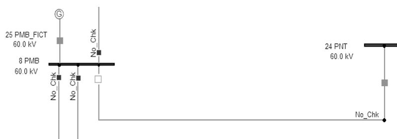
**Figura 4.18** - Alteração da exploração normal da linha com abertura do disjuntor na SE Pombal.
