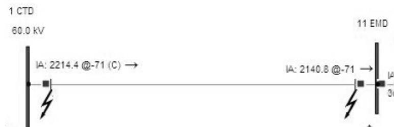
Figura 4.28 - Valores aproximados das correntes de curto-circuitos no extremo da linha Castro D´Aire-Erminda situadas.
