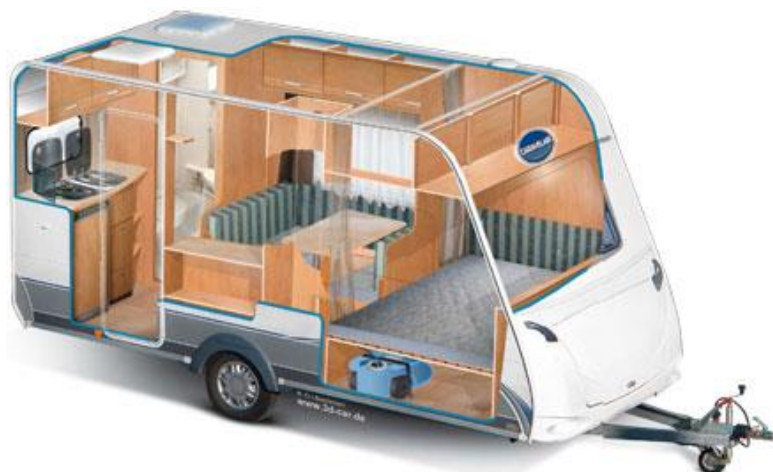
Figura 1.1. Estrutura da caravana Caravelair Antarés Luxe 400 [2]
