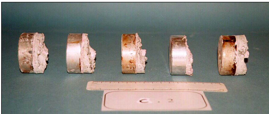
c) Provetes após o "pull-off" no interior da viga C.2 (com carotagem).
