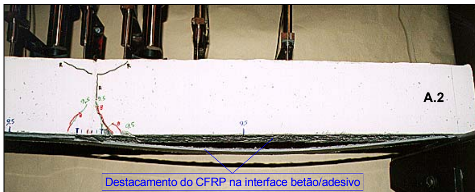
a) Forma do destacamento do laminado
