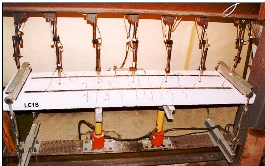
Figura 5.69 – Distribuição inicial da fendilhação na laje LC1S (carga total \cong 16 kN).
