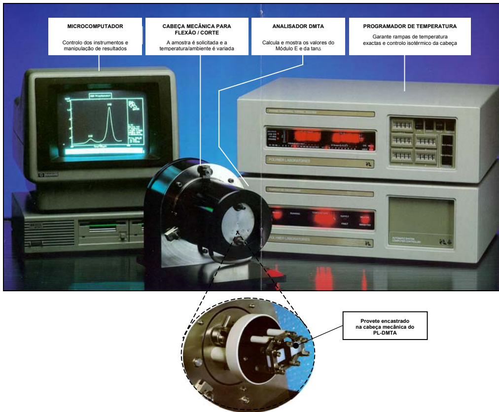
Figura 3.14 – Ensaio de DMTA do adesivo (PL-DMTA, 1991).
