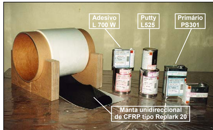
b) Componentes de um sistema de mantas flexíveis de CFRP.
