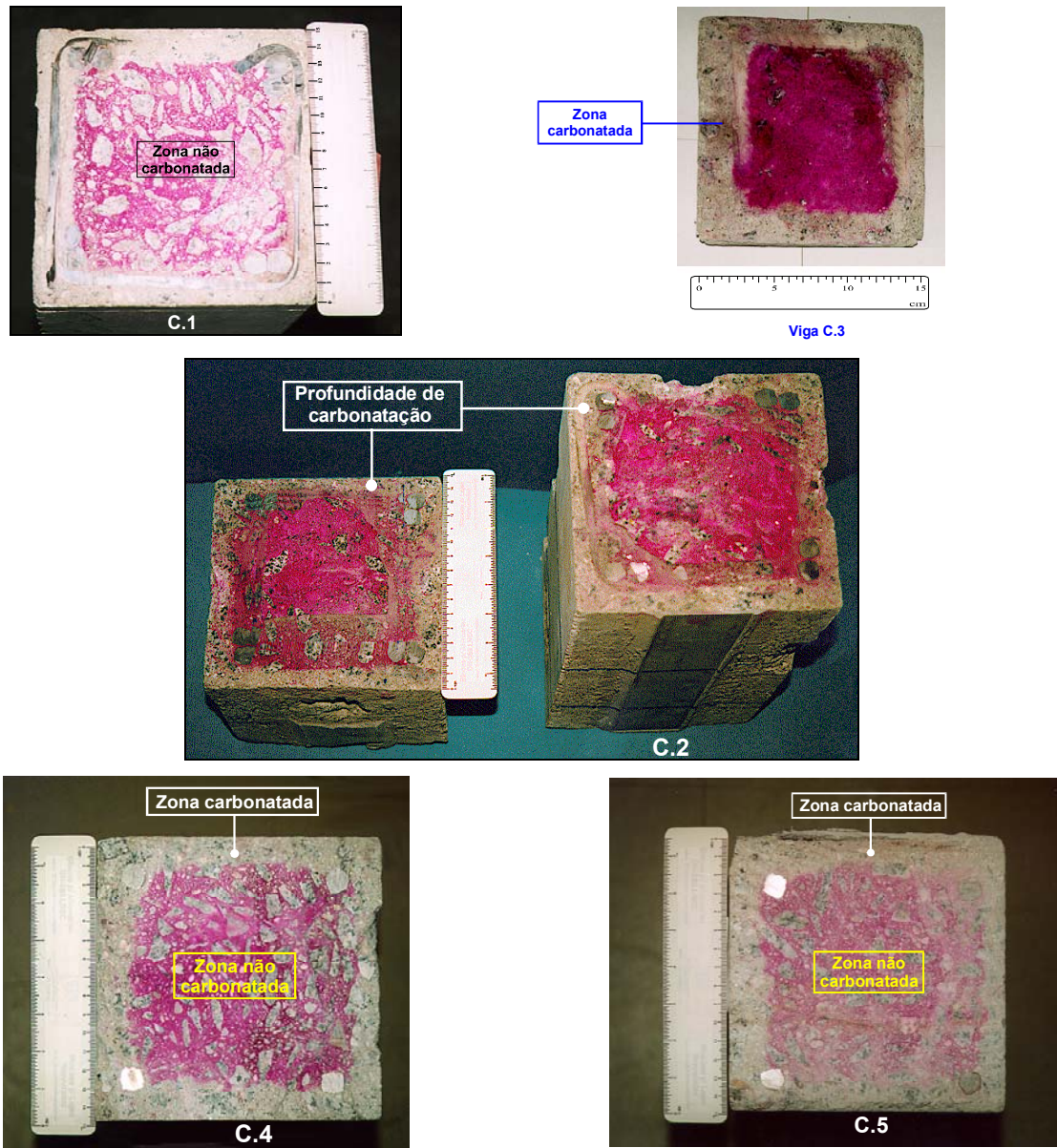
Figura 3.31 – Observação da profundidade de carbonatação nas vigas tipo C .
