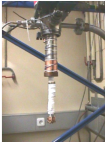
Figura 2.2: Fotografia de um dos criostatos de He, de ciclo fechado (10 - 300 K), utilizado na realização das medidas de resistividade e magnetoresistência.
