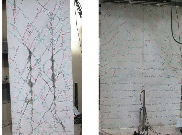
Figura 5.42 – Danos em alma (a) e banzo (b) do pilar PO2-N5-E1
