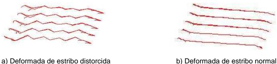
Figura 4.8 – Efeito da amarração dos estribos na respectiva deformada
