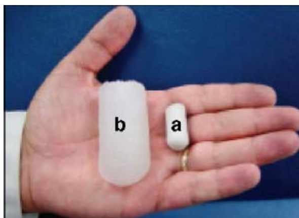
Figura 13 - Sistema Superporoso no estado seco (A) e hidratado (B) – adaptado de Gutierrez et al.
