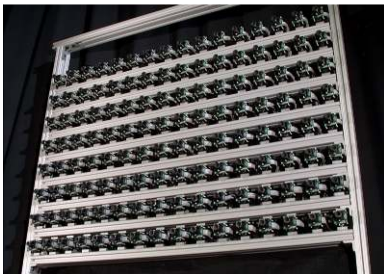
Figura 12: Conjunto de 128 câmaras construído para o projecto inicial Stanford Immersive Television da Universidade de Stanford.
