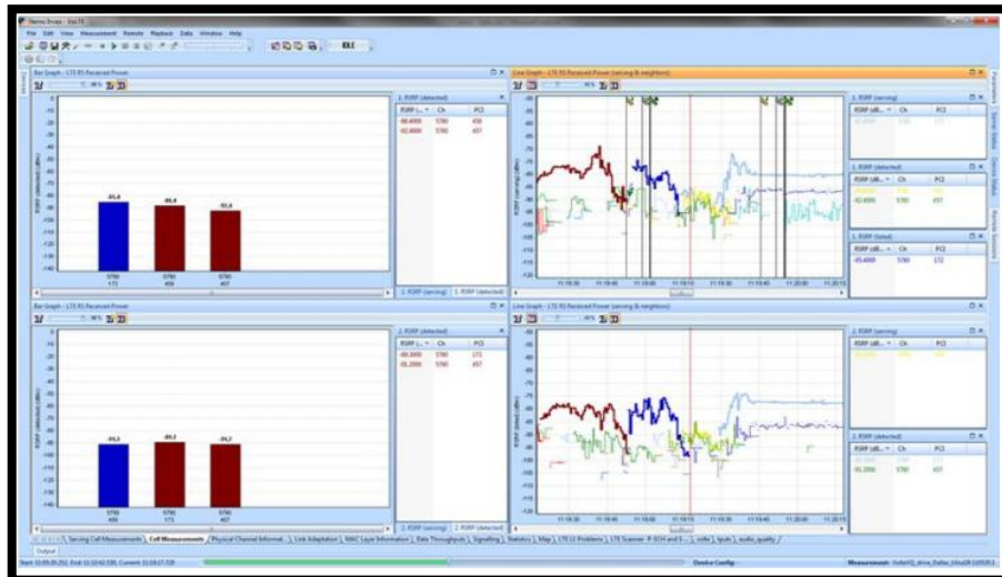
Figura 3.4: Calidad baja de PCI debido a una superposición de PCI y SNR bajo.
