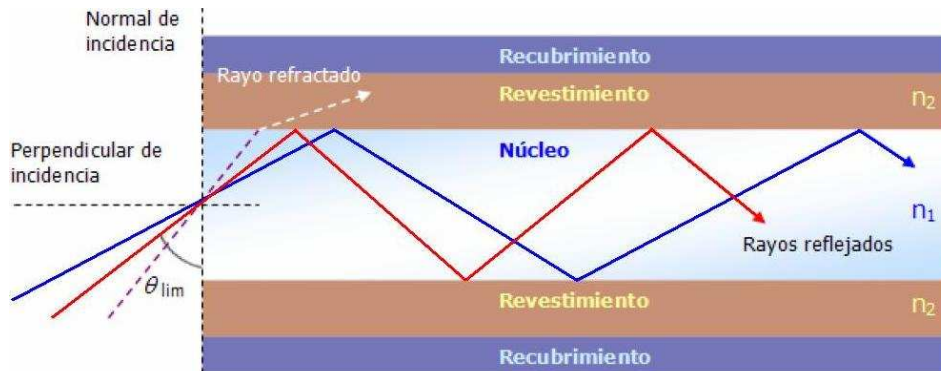
Figura 2.23 Principio de operación de la fibra óptica.
