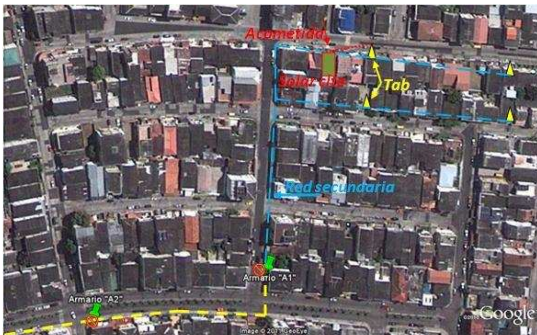
Figura 3.12 Red de fibra óptica conectada al abonado en zona # 6. En la tabla 3.1 se logra observar la simbología que existen en la figura 3.12
