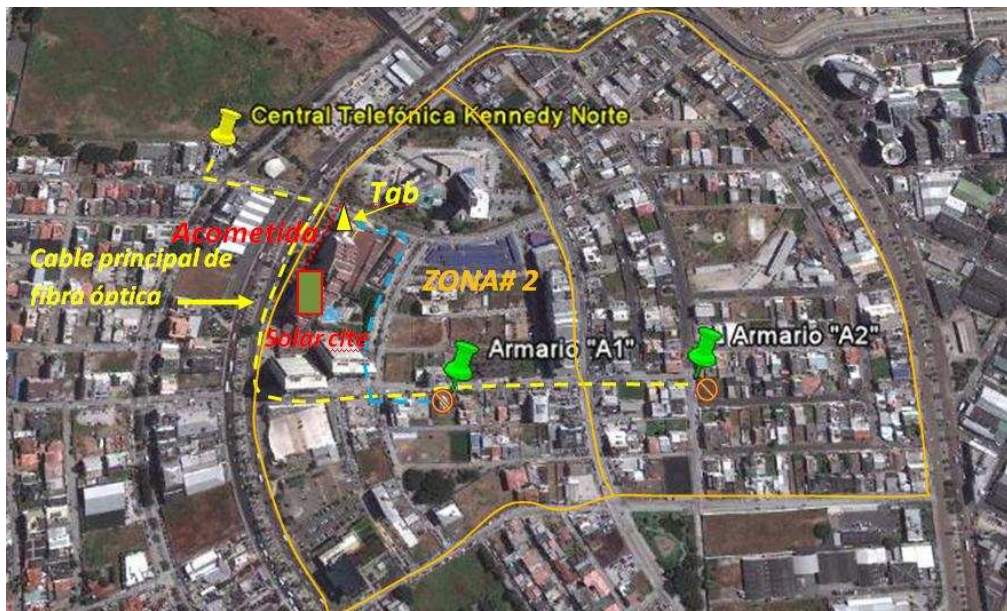
Figura 3.14 Red de fibra óptica conectada al abonado en zona#2.
