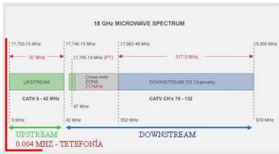
Figura 1.4. Bandas y frecuencias de canales de transmisión HFC.
