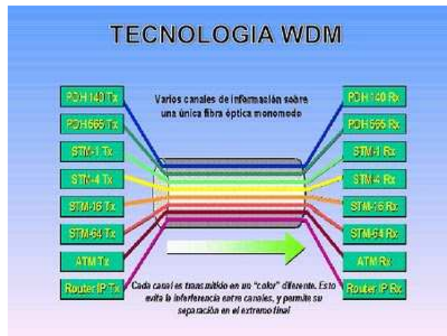
Figura 1.14 Cada canal es transmitido por un solo color diferente.
