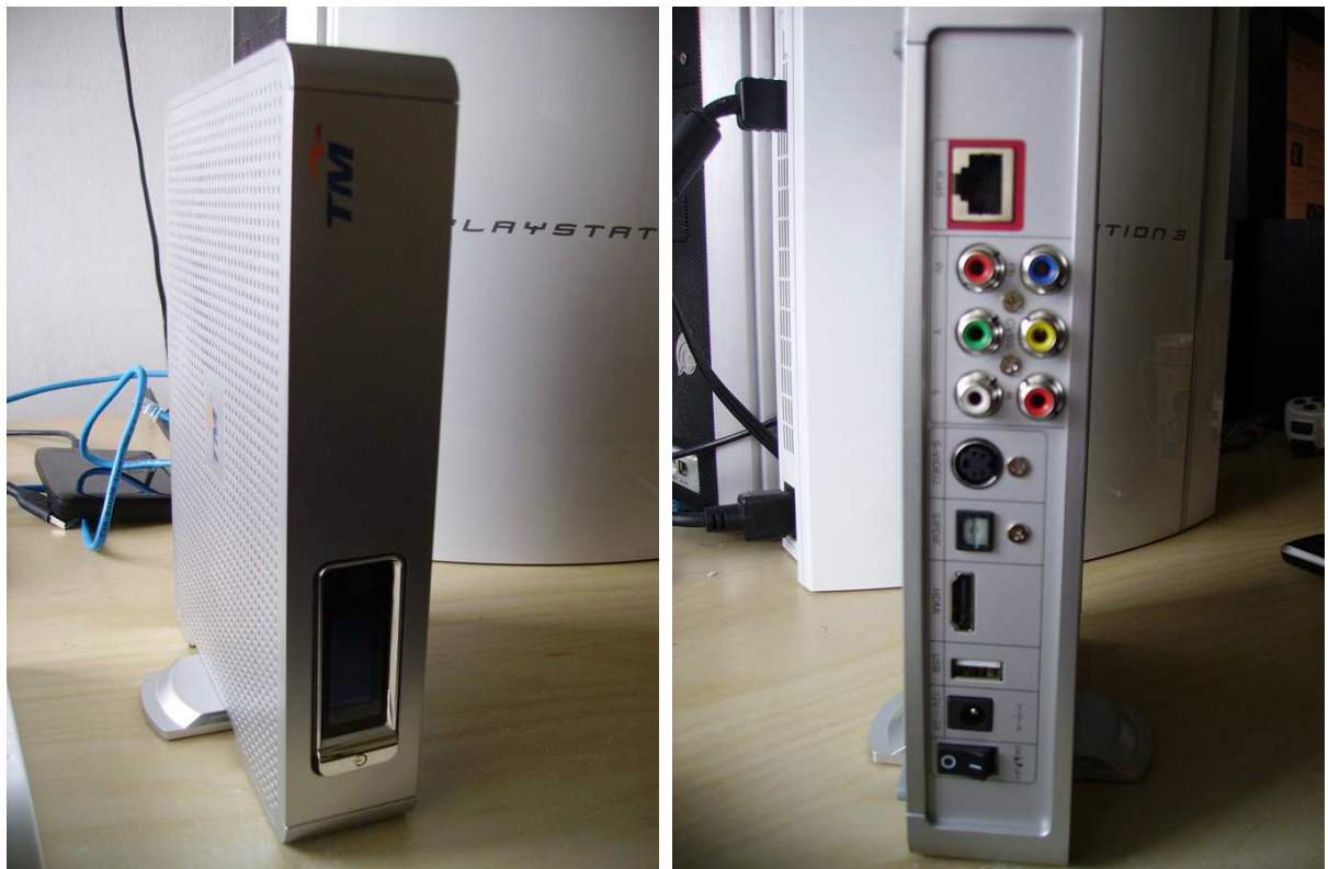
Figura 1.e Caja de conexión para señal de video.
