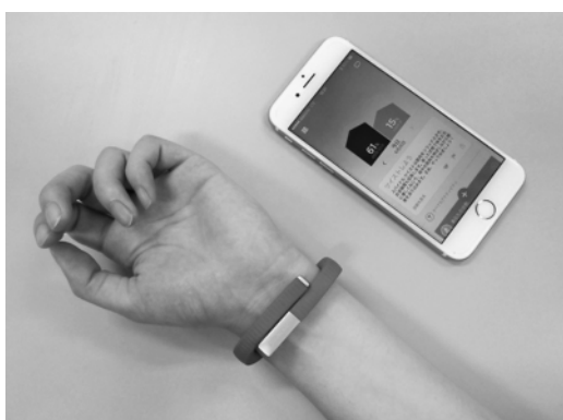
図3 リストバンド型活動量計（JAWBONE UP-24）とスマートフォンとの連動による記録
