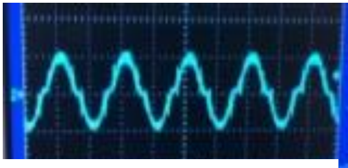
図 a PFC 正常動作の入力電流波形
